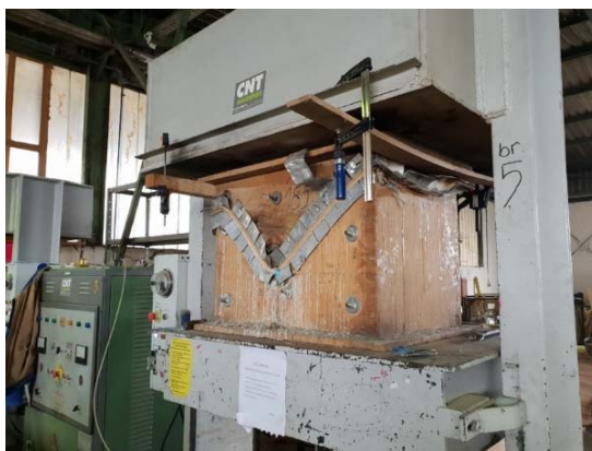
Slika 1. Položaj otpresaka i šablona u VF presi
